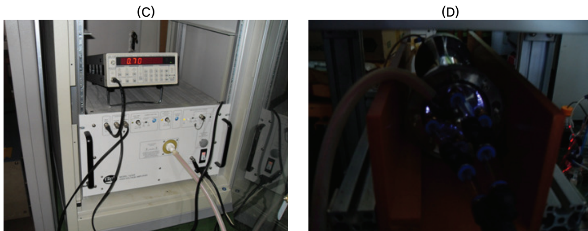
그림 9. 암모니아 및 휘발성 지방산의 저감효율을 평가하기 위한 (A) 약취유입장치 구성, (B) 코로나 방전 반응조, (C) 전력공급기, (D) 코로나 방전.
