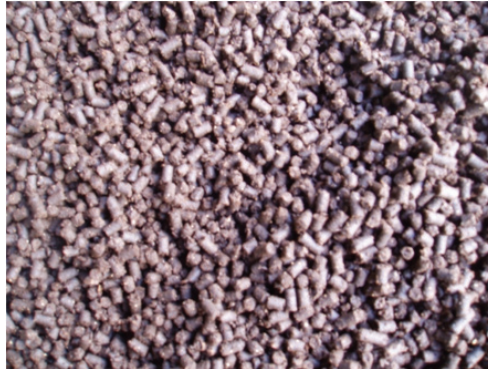
그림 5. 수평형 평판식 펠릿밀 타입 가공기에 의한 펠릿 가공퇴비.
