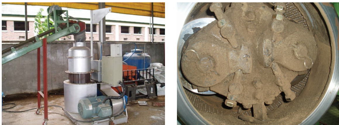
그림 2. 수평식 평판형 펠렛밀(좌)과 링형 펠렛밀 가공기(우).
