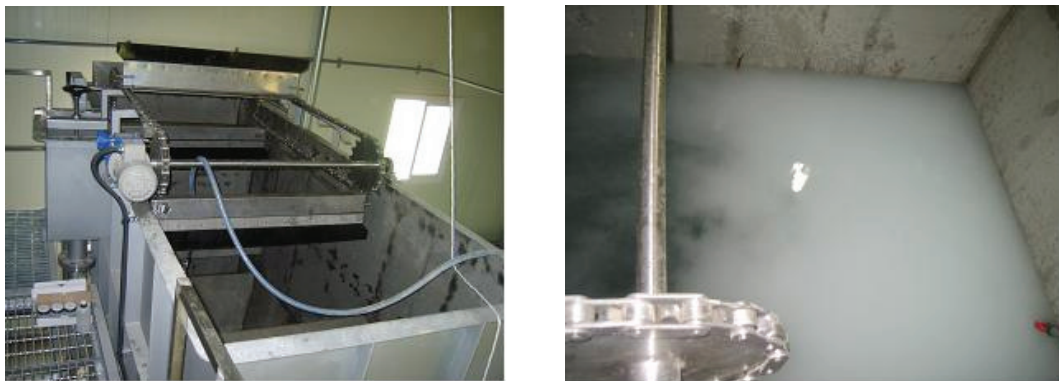
Fig. 4. 실제 농가에 설치된 마이크로버블 고액분리기 및 마이크로버블 발생 모습.
